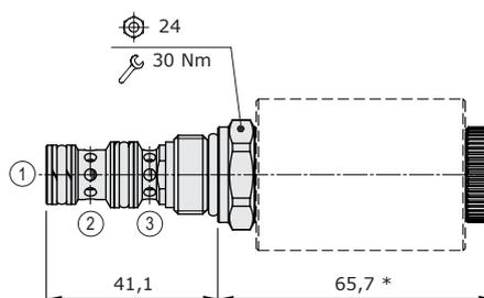
NOTA (\*): dimensione per configurazione **EJ08F/20NB**, per dimensioni con differenti tipi di emergenza vedere pag. 213.
